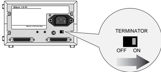
2. Connectez le câble SCSI à l'un des deux connecteurs SCSI situés à l'arrière du scanner et connectez l'autre extrémité au périphérique suivant sur la chaîne.
