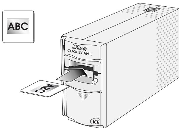
Pour la numérisation d'un film en bande à l'aide de l'adaptateur pour films en bande SA-20, faites glisser la bande, sur une courte distance, dans la fente de l'adaptateur prévue à cet effet. Le mécanisme de chargement de l'adaptateur est alors activé et le film est chargé automatiquement dans le scanner.
