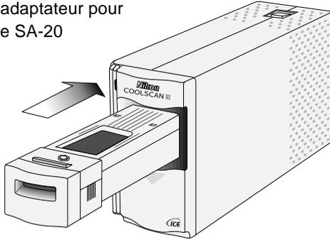
Un bac en plastique est fourni avec l'adaptateur pour films en bande, pour la réception de films que le scanner éjecte. Ce bac est fixé sur l'adaptateur comme l'indique le schéma ci-dessous.
